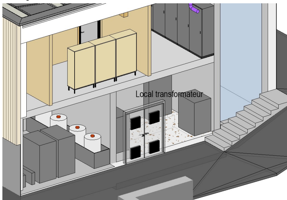
Figure 23 : Raccordement électrique à l'intérieur du bâtiment
